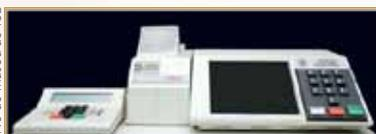
Modelo de urna eleitoral – com Módulo de Impressor Externo (MIE) – utilizado nas eleições de 2002. O MIE foi uma experiência da Justiça Eleitoral em imprimir os votos dados, de forma a não permitir a identificação do eleitor, para que fosse conferido o registro eletrônico com a contagem dos impressos. A intenção era verificar a confiabilidade da urna eletrônica. O resultado foi considerado positivo e o MIE foi abandonado nos modelos subsequentes.
