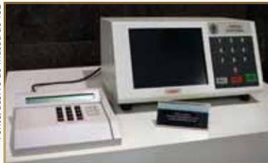
Primeiro modelo de urna eletrônica a ser utilizado nas eleições municipais de 1996. Possui tela de LCD, bateria interna e teclado em membrana.
