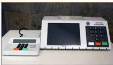
Modelo de urna eletrônica de 2004, sem o Módulo de Impressor Externo (MIE). Possui alterações nos recursos tecnológicos com relação aos modelos anteriores.
